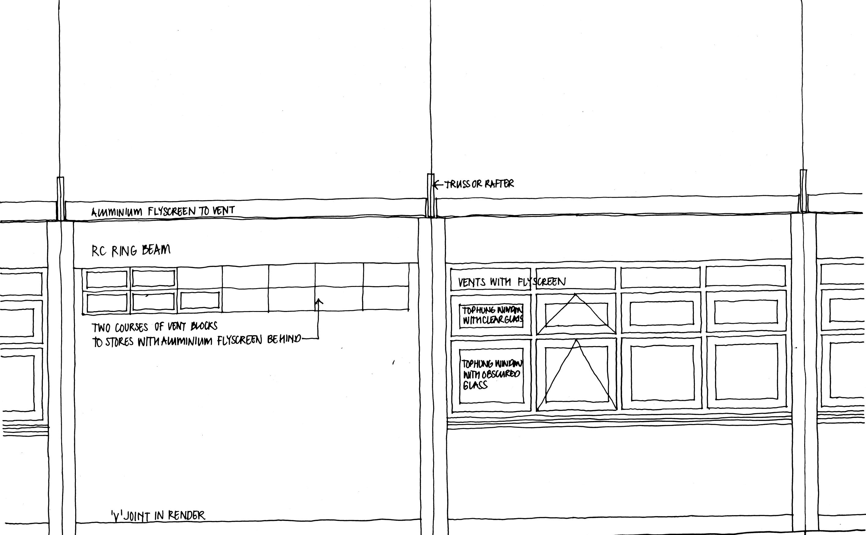
PART REAR ELEVATION WITH TOP-HUNG TIMBER WINDOWS
